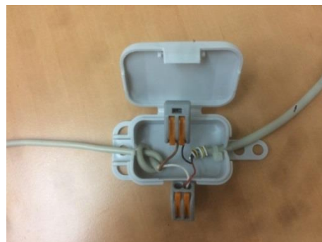
Bild 2: Mindestgröße der Verbindungsdose
